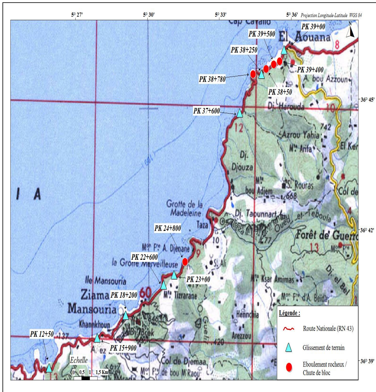
Figure IV. 29. Carte d’inventaire des principaux mouvements de terrain rencontrés le long du tronçon d’étude (El-Aouna-Ziama Mansouriah) sur la RN 43
